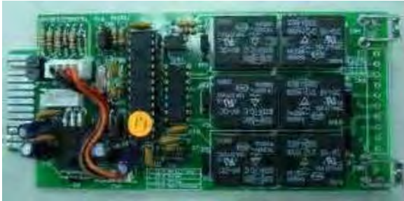
Fig. 8-3-5 – 1 Carte enfichable à contact de relais (carte DCE-B)
