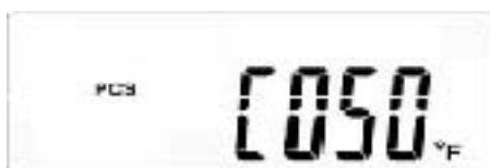
Fig. 7-4 – 4 Affichage J – Température interne °F de l'onduleur photovoltaïque
