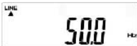
Fig. 7-4 – 13 Affichage S – Fréquence de l'onduleur photovoltaïque Tension de sortie
