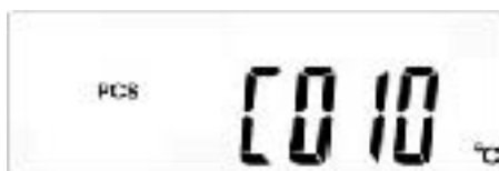
Fig. 7-4 – 2 Affichage H – Température interne °C de l'onduleur photovoltaïque
