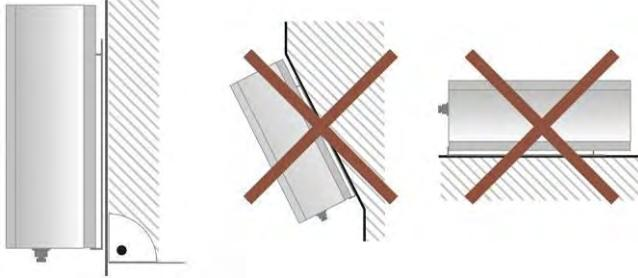
Fig. 4-1 Conditions d'environnement pour le montage (orientation)
