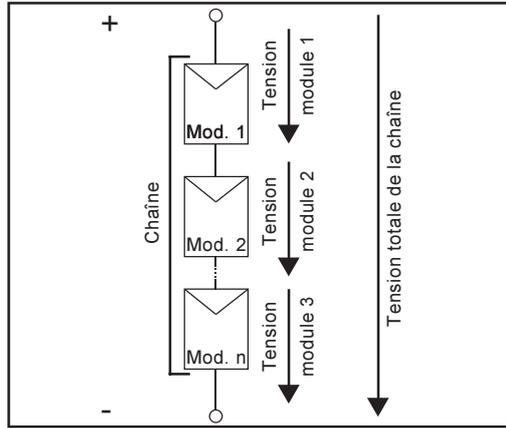
Puissance et tension sont augmentées en utilisant parallèlement plusieurs modules solaires. En montant les modules solaires en série pour en faire une chaîne, on augmente les deux, donc à la fois la puissance possible et la tension.
