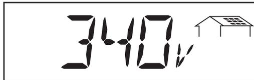
**Tension des modules ...** la tension mesurée à ce moment sur les modules solaires (volt)
