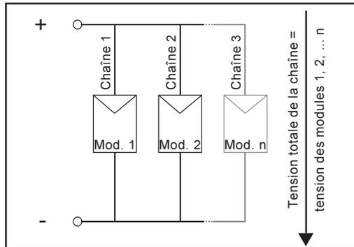
Lorsque l'on relie parallèlement plusieurs de ces chaînes, on augmente la puissance possible et le courant des modules, la tension reste la même. La totalité de tous les modules solaires reliés parallèlement et en série est appelé générateur photovoltaïque.
