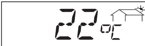
\*\* **Température ambiante** (°C ; également réglage sur °F dans le menu Setup ; capteur de température n° 2 ; option carte capteur)
