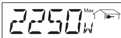
**Puissance maximale injectée** ... puissance maximale injectée dans le réseau dans l'espace temps considéré (W)
