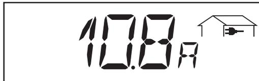
**Courant injecté ...** le courant injecté à ce moment dans le réseau (ampère)
