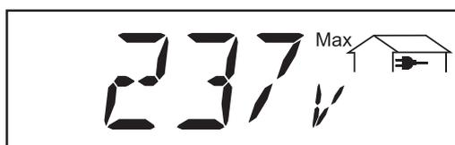
**Tension maximale du réseau** ... tension de réseau maximale mesurée dans l'espace temps considéré (V)
