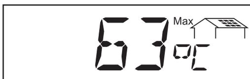
\*\* **Température ambiante maximale des modules** ... la température la plus élevée mesurée sur les modules solaires dans l'espace temps considéré (°C ; également réglage sur °F dans le menu Setup ; capteur de températ. n° 1 ; option carte capteur)
