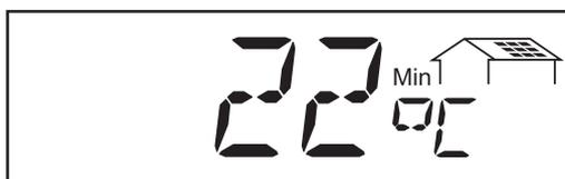
\*\* **Température ambiante minimale des modules** ... la température la plus basse mesurée sur les modules solaires dans l'espace temps considéré (°C ; également réglage sur °F dans le menu Setup ; capteur de températ. n° 1 ; option carte capteur)
