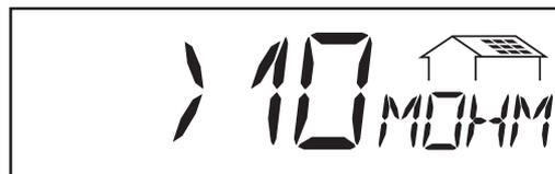
**Résistance d'isolement de l'installation photovoltaïque** (mohm)
