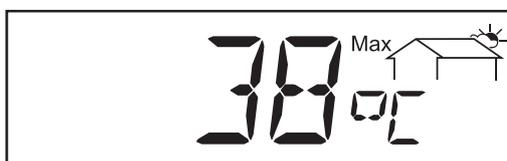
\*\* **Température ambiante maximale** ... la température la plus élevée mesurée dans l'espace temps considéré (°C ; également réglage sur °F dans le menu Setup ; capteur de température n° 2 ; option carte capteur)
