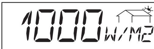
\*\* **Rayonnement solaire** ...puissance de rayonnement par mètre carré (watt/m<sup>2</sup> ; option carte capteur)
