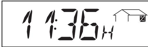
**Heures de service** ... Durée de fonctionnement du FRONIUS IG (HH:MM)
