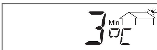
\*\* **Température ambiante minimale** ... la température la plus basse mesurée dans l'espace temps considéré (°C ; également réglage sur °F dans le menu Setup ; capteur de température n° 2 ; option carte capteur)
