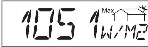
**\*\* Rayonnement solaire maximal** ... le rayonnement solaire le plus fort survenu dans l'espace temps considéré (W/m<sup>2</sup> ; option carte capteur)
