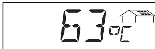
\*\* **Température ambiante des modules ...** Température des modules solaires (°C ; également réglage sur °F dans le menu Setup ; capteur de température n° 1 ; option carte capteur)
