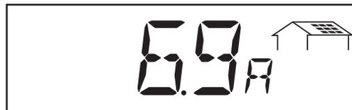
**Courant des modules ...** le courant fourni à ce moment par les modules solaires (ampère)
