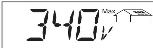
**Tension maximale des modules** ... la tension la plus haute mesurée sur les modules dans l'espace temps considéré (V)
